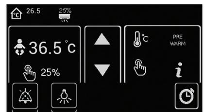
En MODE MANUEL, le réchaud fournit une puissance de chauffage réglable par l'utilisateur et la possibilité de surveiller la température de la peau du bébé à l'aide d'un capteur de peau.
