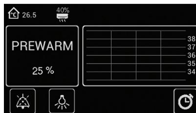
En mode PRE-CHAUFFAGE, le réchauffeur assure un préchauffage général sans alarme du réchauffeur et de l'environnement au-dessus du matelas chauffant.
