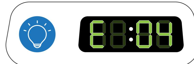
Khi đèn chiếu hoạt động được 60 000 giờ và kể từ đó, mã E04 sẽ xuất hiện trên màn hình hiển thị. Điều này chỉ ra rằng các bóng đèn LED đã đạt tới tuổi thọ được khuyến cáo. Thông tin này sẽ được hiển thị trong 5 giây sau khi bật máy, tiếp theo, tổng số giờ đã sử dụng sẽ xuất hiện trong 3 giây. Sau đó, mã E04 và tổng số giờ sử dụng sẽ luôn hiển thị trong mỗi giây tiếp theo.
