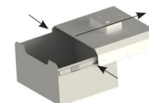
**3B** Fije la parte superior a la unidad de control. Utilice 2 x tornillo M10x25
