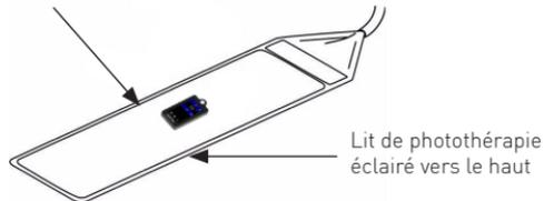
3. Lisez la mesure de rayonnement sur l'écran. Ajustez l'objectif du capteur de photomètre pour obtenir la lecture maximale.
