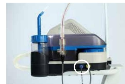
F. Reliez la sonde de température T1 au port situé dans le logement du câble du réchauffeur (cercle blanc) et T2 au port du connecteur droit (cercle noir).
