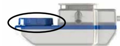
**D.** Placez l'humidificateur dans le bon sens sur une surface plane. Attendez 1 minute et observez si de l'eau fuit du bouchon en métal ou du bouchon à vis.
