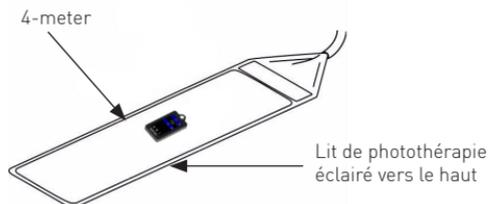
3. Lisez la mesure d'éclairement sur l'écran. Ajustez l'objectif de 4-meter pour obtenir la lecture maximale.
