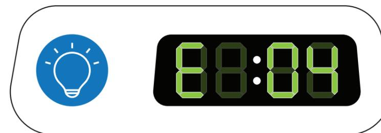
Khi đèn chiếu hoạt động được 60 000 giờ và kể từ đó, mã E04 sẽ xuất hiện trên màn hình hiển thị. Điều này chỉ ra rằng các bóng đèn LED đã đạt tới tuổi thọ được khuyến cáo. Thông tin này sẽ được hiển thị trong 5 giây sau khi bật máy, tiếp theo, tổng số giờ đã sử dụng sẽ xuất hiện trong 3 giây. Sau đó, mã E04 và tổng số giờ sử dụng sẽ luân phiên hiển thị trong mỗi giây tiếp theo.
