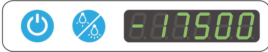
La pantalla muestra el "total de horas del dispositivo". Esto aparecerá durante 3 segundos.
