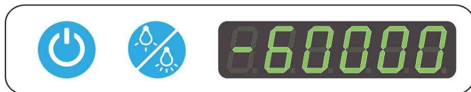
Si Colibri se utiliza más de 60.000 horas, después de encender el aparato la pantalla mostrará el "total de horas del dispositivo" durante 3 segundos y aparecerá después el mensaje "Error 4". Este mensaje de error aparecerá cada segundo durante el tratamiento.
