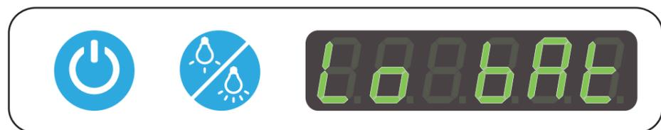
Cuando el voltaje de celda más bajo alcanza los 3V, el dispositivo informa sobre baterías bajas.
