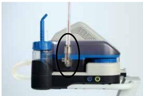
**B.** Присоедините экспираторную трубку к колонке PEEP.
