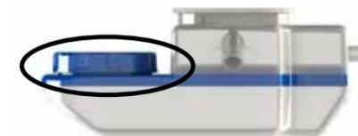
**D.** Установите увлажнитель на ровную поверхность лицевой стороной вверх. Подождите 1 минуту и посмотрите, не вытекает ли вода из металлической пробки или винтовой крышки.
