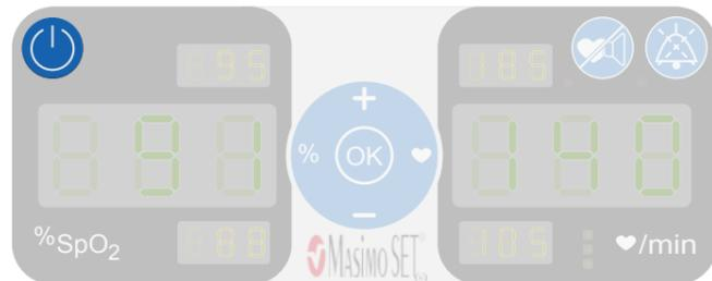
**i** Если Dolphin CPAP теряет питание от сети, значения SpO<sub>2</sub> и частоты пульса будут сохраняться до следующего включения дисплея пульсоксиметра. Если Dolphin CPAP выключен с помощью кнопки питания, предельные значения сигналов тревоги сохраняться не будут.
