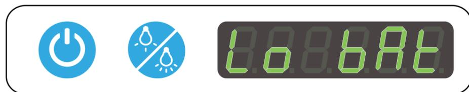
Lorsque la tension de cellule la plus basse atteint 3V, l'appareil informe sur les piles faibles.
