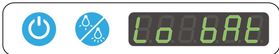
Cuando el voltaje de celda más bajo alcanza los 3V, el dispositivo informa sobre baterías bajas.
