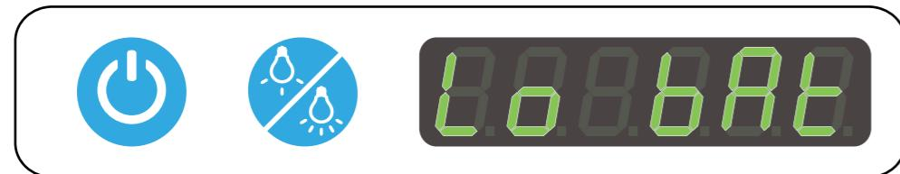
Khi điện áp của cell pin xuống mức thấp nhất là 3V, thiết bị cảnh báo pin yếu. “Lo bAt” và âm thanh báo động kéo dài 10 giây sau đó các thiết bị sẽ tự tắt.
