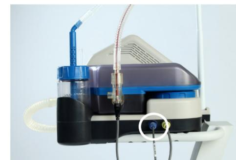
F. Conectar la sonda de temperatura T1 al puerto de la carcasa del cable calefactor (círculo blanco) y la T2 al puerto del conector recto (círculo negro).
