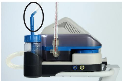
C. Conectar el enchufe amarillo del cable de alimentación del cable calefactor al conector hembra amarillo del aparato.
