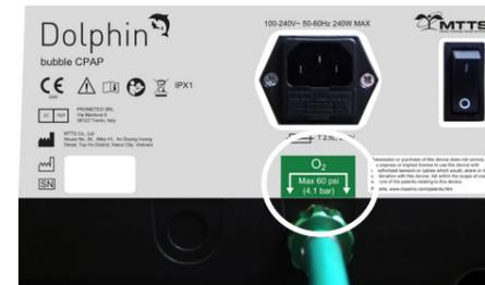
**i** Las fuentes de gas deben proporcionar una presión dentro del rango de 10 a 60 psi (0,7 a 4,1 bar). Si las fuentes de gas están fuera de este rango, el aparato podría no ser capaz de producir la tasa de flujo deseada ni el %FiO<sub>2</sub>.
