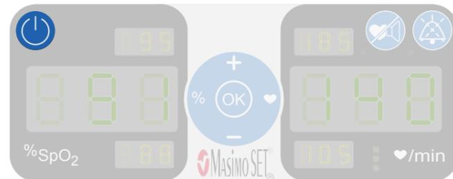
**i** Si el Dolphin CPAP se desconecta de la red eléctrica, los valores de la alarma de la SpO<sub>2</sub> y de la frecuencia cardíaca se guardarán hasta que la pantalla del pulsioxímetro vuelva a encenderse. Si el Dolphin CPAP se apaga con el botón de encendido y apagado, no se guardarán los valores límite de la alarma.
