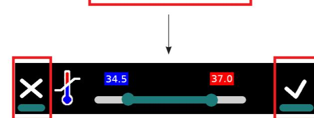
La alarma de temperatura de la piel BAJA o ALTA se indica mediante una barra roja intermitente debajo de la pantalla de temperatura de la piel. La alarma se activa cuando la temperatura real supera el punto de ajuste en más de 1 °C.
