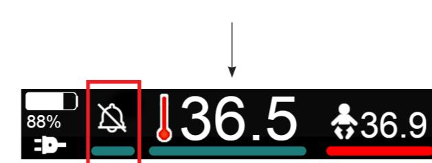
El silenciamiento de la alarma se indica mediante un símbolo de silencio marcado con un color. El dispositivo puede permanecer silenciado durante un máximo de 10 minutos.
