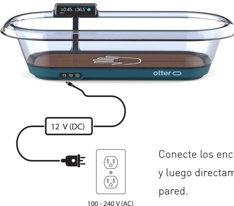
Conecte los enchufes al cuadro eléctrico de Otter y luego directamente a la toma de corriente de la pared.
