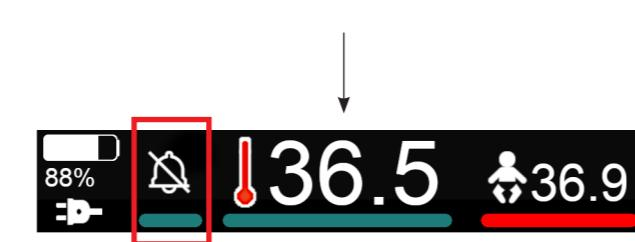
La désactivation de l'alarme est indiquée par un symbole de désactivation marqué d'une couleur. L'appareil peut être désactivé pendant 10 minutes maximum.
