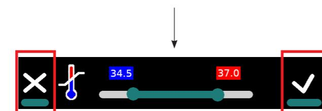
L'alarme de température cutanée BASSE ou ÉLEVÉE est indiquée par une barre rouge clignotante sous l'affichage de la température cutanée. L'alarme se déclenche lorsque la température réelle dépasse le point de consigne de plus de 1 °C.
